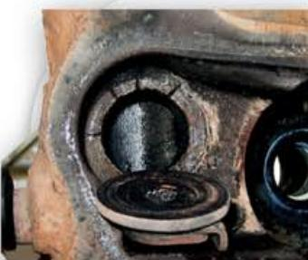
**Motivo:** Inyección fuera de punto, obstrucción del filtro del aire o el intercooler.
