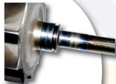
**Revisar:** Lo primero que el nivel y estado de viscosidad del aceite es el adecuado, los latiguillos de entrada y aceite al turbo, y el estado y colocación de las juntas, y que la bomba de aceite funciona y proporciona la presión adecuada. También que no hay alguna rotura en las conducciones del agua que se comuniquen con el aceite.
