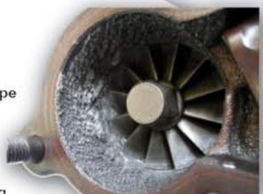
**Observaciones:** Al mismo tiempo que se repara el motor y el turbo, hay que limpiar o reemplazar el colector de escape para que no quede ninguna partícula de aluminio. Si no eliminamos el aluminio del colector de escape al volver arrancar el motor y calentarse se fundirá y volverá a impactar contra la turbina de escape.
