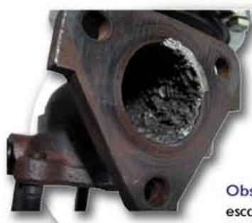
**Motivo:** Rotura de un pistón del motor.
