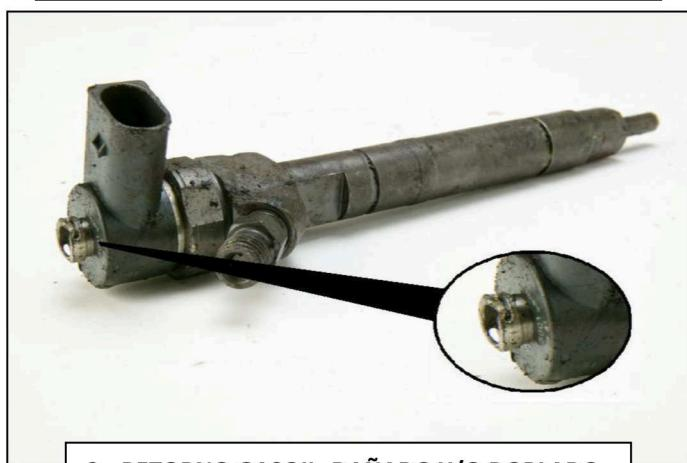
3.- RETORNO GASOIL DAÑADO Y/O DOBLADO
