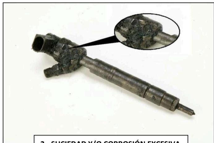
2.- SUCIEDAD Y/O CORROSIÓN EXCESIVA
